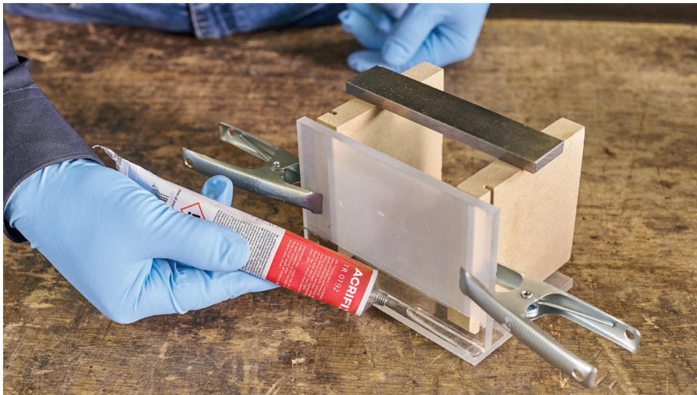
PLEXIGLAS® Platten lotrecht verkleben mit fugenfüllendem ACRIFIX® 1R 0192
