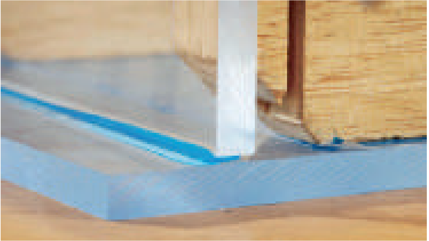
ACRIFIX® 1R 0192 kriecht selbständig in den Klebespalt hinein.
