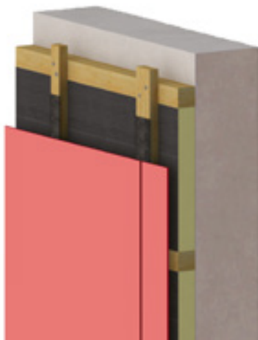
Konstruktion mit horizontaler Konterlattung
