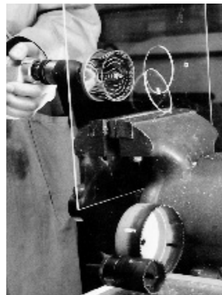
Abb. 17: Sägeglocke und Lochsäge
