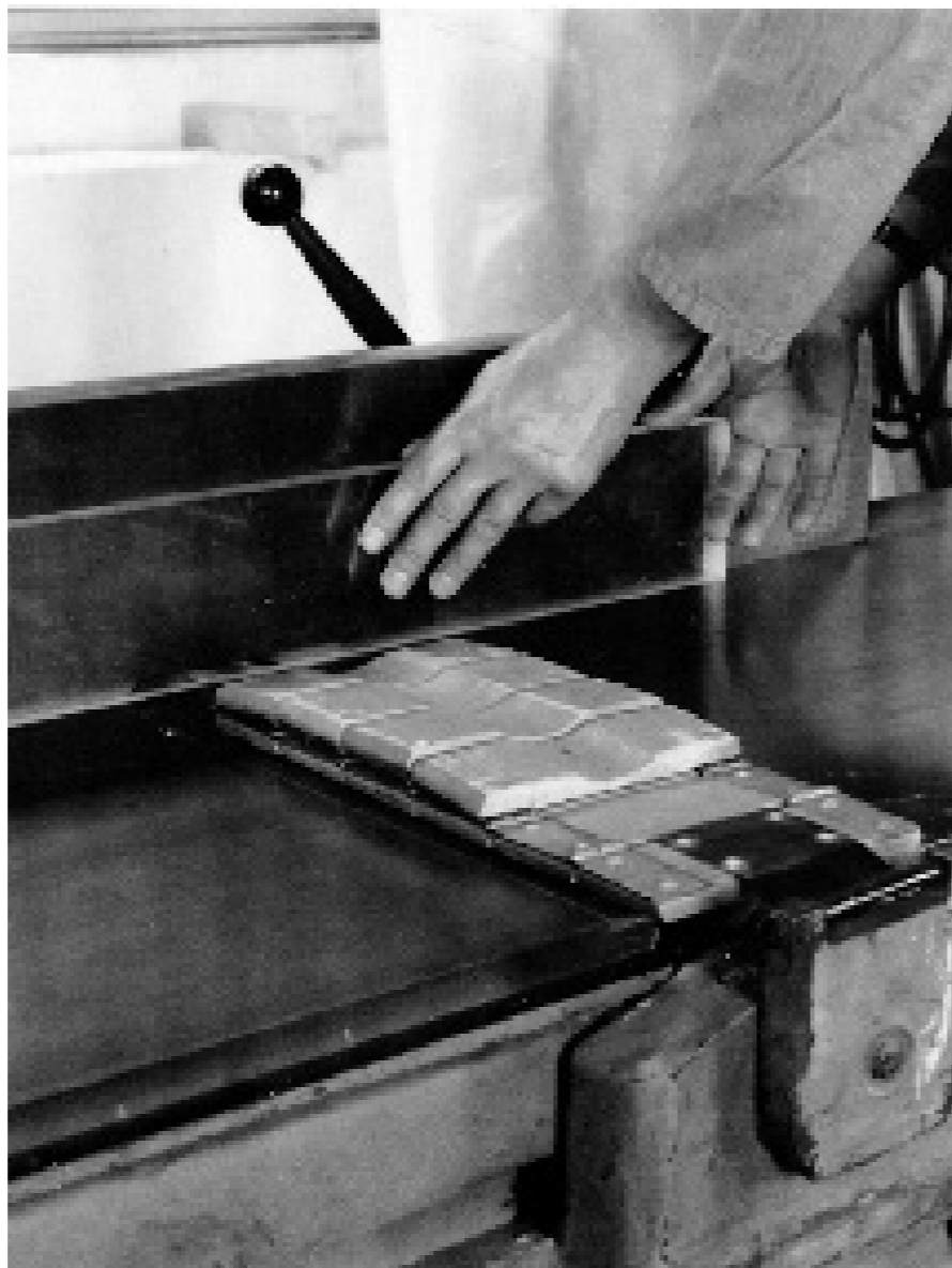
Abb. 36: Glätten der Kanten mit Abrichthobel
