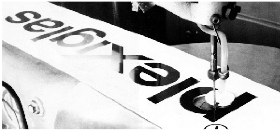
Abb. 9: Schwingsäge schneidet Schriftzug PLEXIGLAS®
