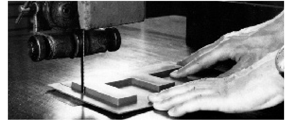
Abb. 7: Trennschnitt mit Bandsäge
