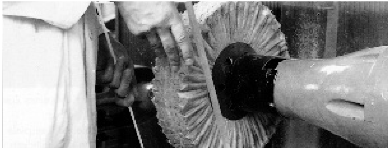
Abb. 40: Polieren an der Stoffschwabbelscheibe
