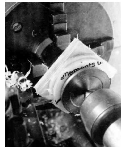
Abb. 30: Scheiben-Runddrehen zwischen Spannfutter und Reitstock
