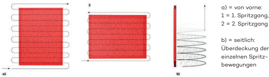
Abb. 4: Führen der Spritzpistole im sog. Kreuzgang
